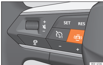
Sl. 93 Lijeva strana višenamjenskog kola upravljača: tipka sustava potpore za vozača (ovisno o modelu).
