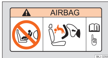
Sl. 35 Etiketa zračnog jastuka: na zaslonu za sunce na suvozačevoj strani.
