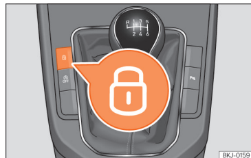
Sl. 52 Središnja konzola: tipka centralnog zaključavanja.
