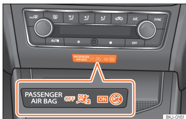
Sl. 30 Srednji dio instrumentne ploče: kontrolna žaruljica za isključeni suvozačev prednji zračni jastuk.
