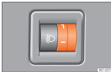
Sl. 72 Pored kola upravljača: regulator za regulaciju visine svjetlosnog snopa.
