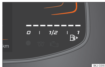
Sl. 5 Kombinirani instrument Basic: pokazivač zalihe goriva.
