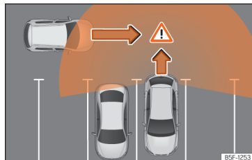
Sl. 157 Shematski prikaz potpore izlaska iz parkirnog mjesta: nadzirano područje vozila koje izlazi iz parkirnog mjesta.
