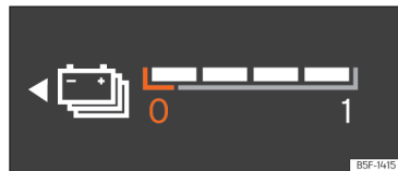
Sl. 8 Digitalni kombinirani instrument: prikaz stanja napunjenosti baterije.
