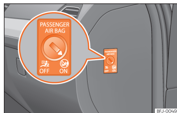
Sl. 32 Bravica za uključivanje i isključivanje suvozačevog zračnog jastuka.
