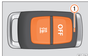
Sl. 114 Grijanje vozila u mirovanju: s daljinskim upravljačem na radiosignal
