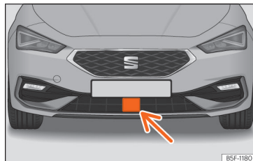
Sl. 123 U prednjem braniku: radarski senzor.
