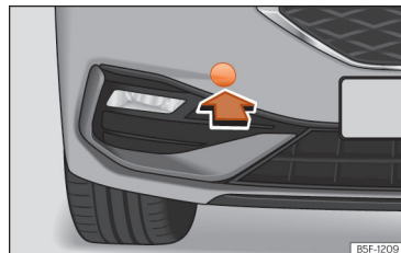
Sl. 211 Na desnoj strani prednjeg branika: skidanje poklopca.
