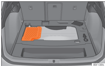
Sl. 229 Plug-in hibridna vozila (PHEV): mjesto ugrađnje akumulatora u prtljažniku
